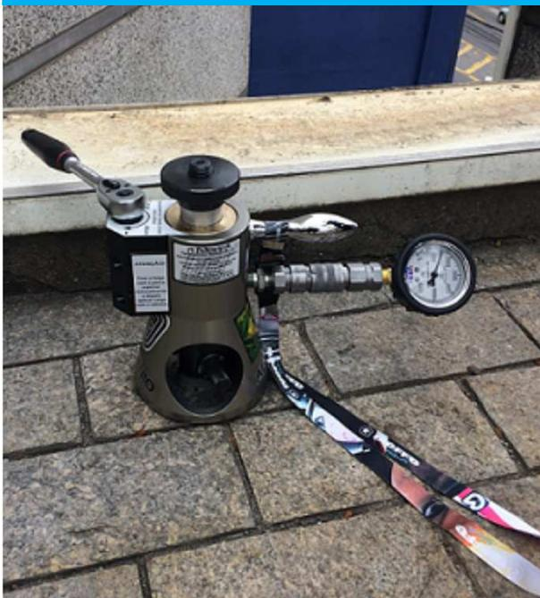
Desenvolvido para atender a NR-35 que obriga o teste de todos os pontos de ancoragens utilizados. Sua capacidade de teste é de até 6.000kgf.
